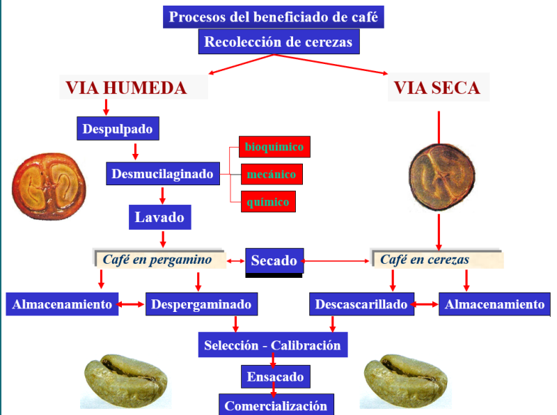
Figura 3. Proceso de beneficiado por vía húmeda y vía seca.
