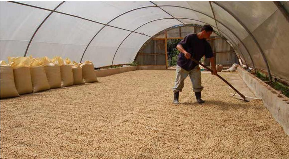
**Túneles** El secador solar tipo túnel es una estructura construida en madera o en tubos de hierro, con cubierta plástica para proteger al café de la lluvia. La estructura cuenta además con la ventilación adecuada que permite la circulación del aire. Las prácticas de manejo es la misma que el secado a pleno sol, exceptuando el retiro diario del café y las previsiones en épocas de lluvia.
