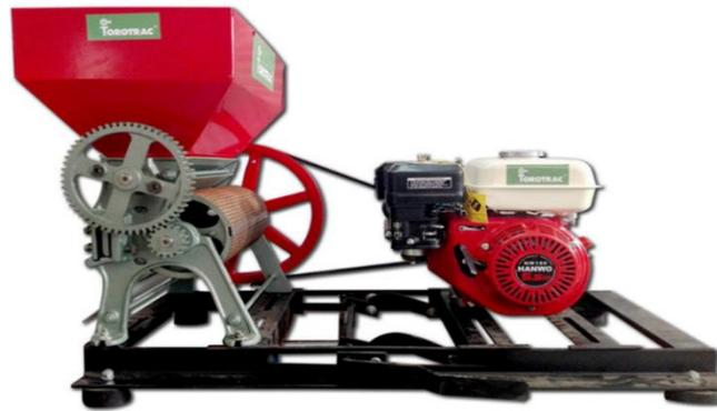
**Gráfico 9.** Máquina despulpadora de café
